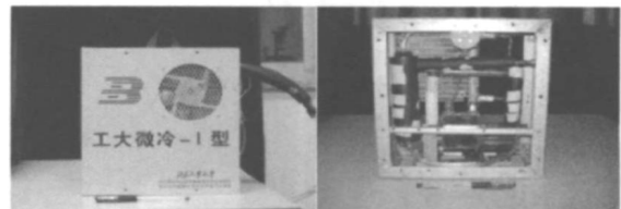
图 4 北京工业大学研制的微型制冷系统
